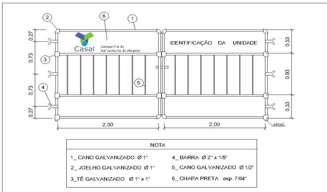
A esquadria será fixada através de chumbadores de penetração em aberturas no concreto, será escorada e mantida no prumo até o completo endurecimento da argamassa.
