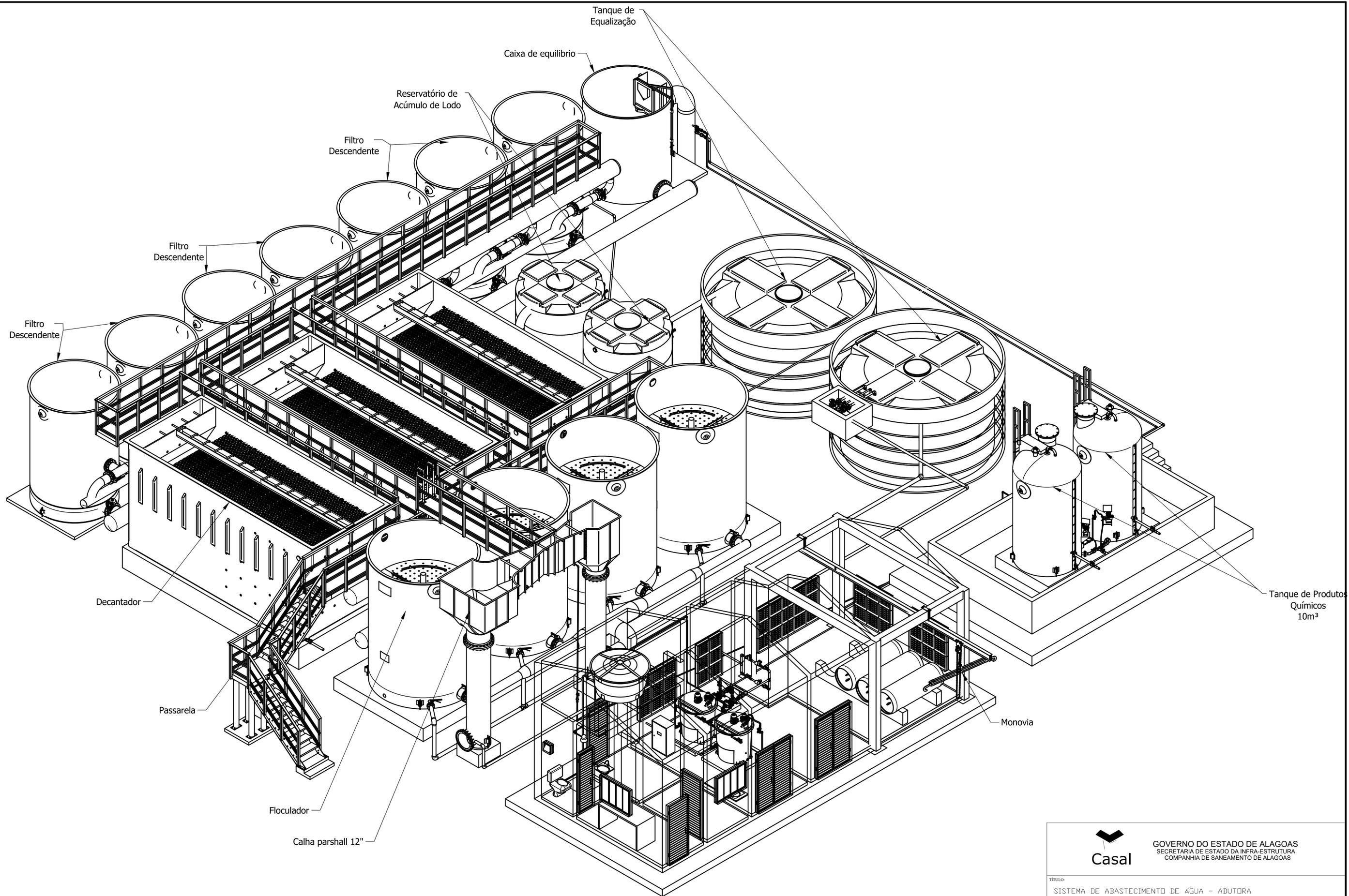
ISOMÉTRICO - ESTAÇÃO DE TRATAMENTO DE ÁGUA
