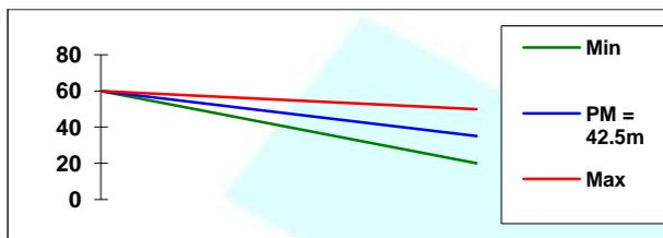
**Pressão média em uma área com VRP e Controlador com modulação por Vazão:**
