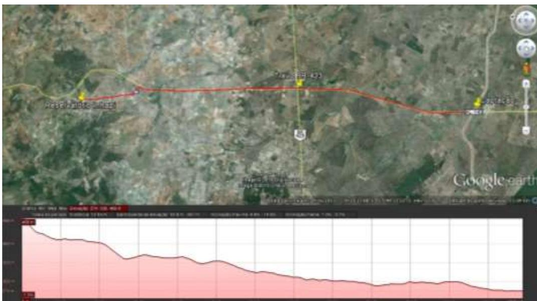
Figura 2 – Traçado da adutora e perfil topográfico.
