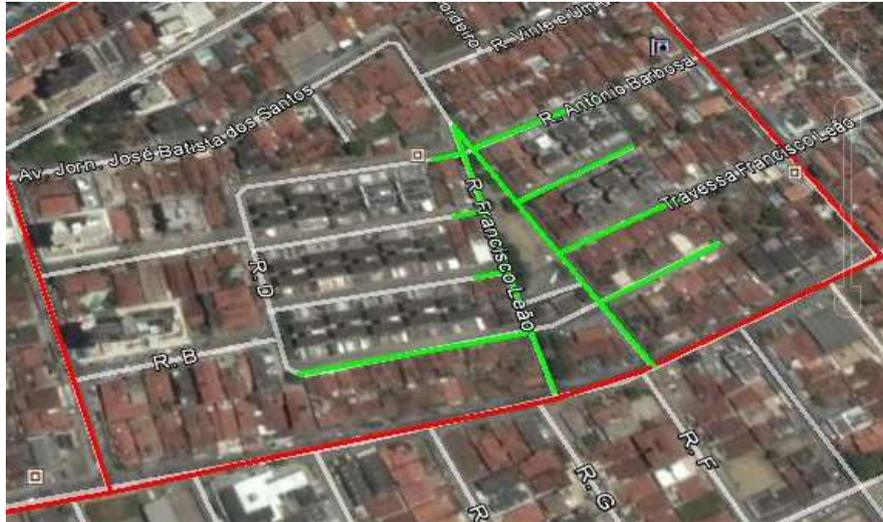
Figura 2 - Tubulações de cimento amianto a serem substituídas (Fonte: Google Earth, 2017)
