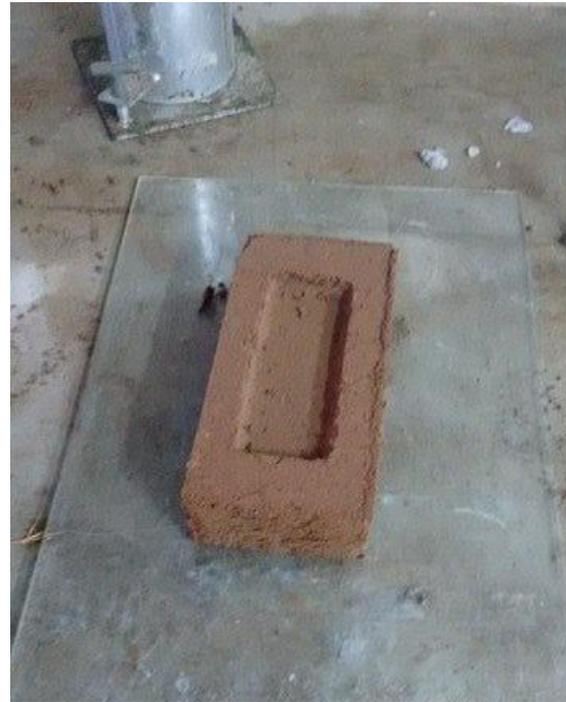
Conforme mostrado na Tabela 3 os corpos de prova apresentaram uma perda de massa dentro dos padrões especificados na norma, que atribui uma perda máxima de massa para o tijolo de solo-cimento de 5%. Nota-se ainda que quanto mais se aumenta à quantidade de lodo a composição maior será a tendência de se aumentar a perda de massa por imersão do tijolo para cada dosagem considerada de solo-cimento.
